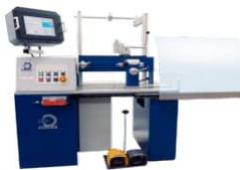
Станок тороидальной намотки RWE-Global
